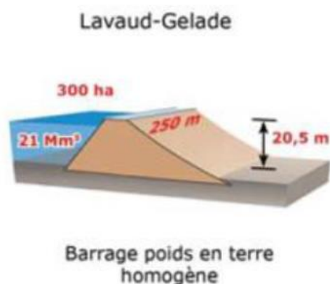
Caractéristiques techniques du barrage de Lavaud-Gelade (Source : DDRM Haute Vienne)
